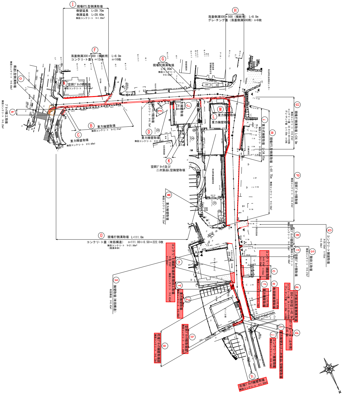
構造物及側溝取壊平面図その1 S=1:500
