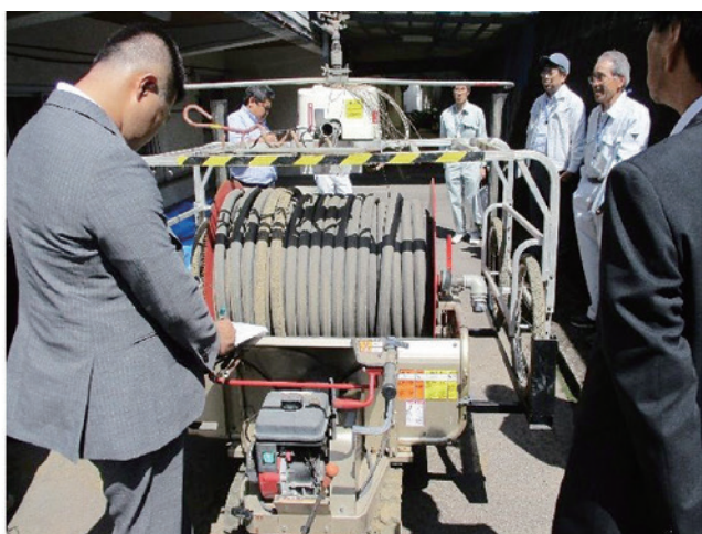
(2) 水圧で駆動する走行式散水器具
